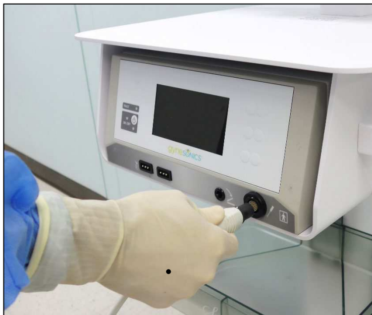
Abbildung 2-3. RFA-Handstück an Vorderseite des RF-Generators anschließen.
