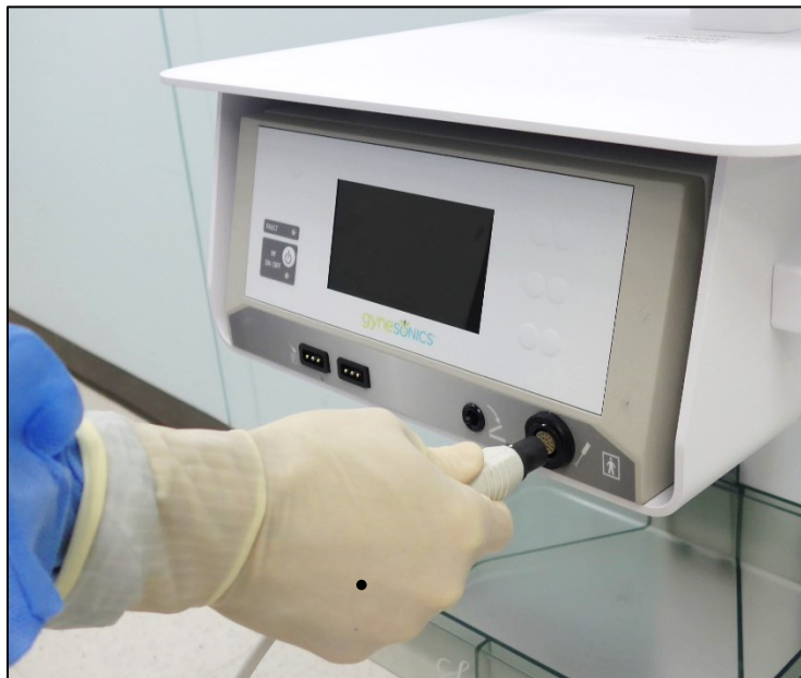
Afbeelding 2-3. RFA-handstuk op de voorkant van de RF-generator aansluiten.
