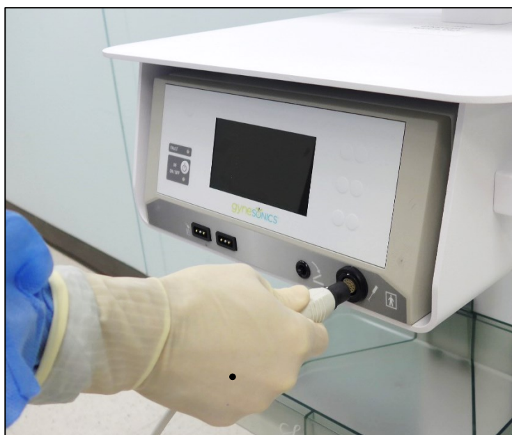
Figure 2-3. Raccorder la pièce à main ARF à la partie avant du générateur RF.
